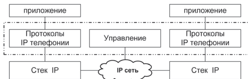
Рис. 1. Механизм сигнализации в сетях IP-телефонии
